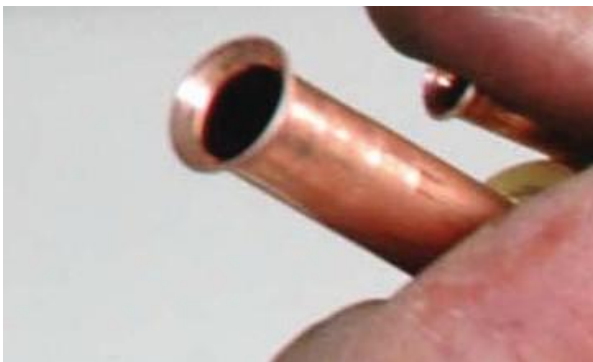
Figure 35: Flare the end of the tube (D)
