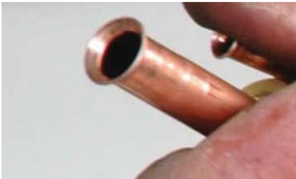
Figure 35: Flare the end of the tube (D)
