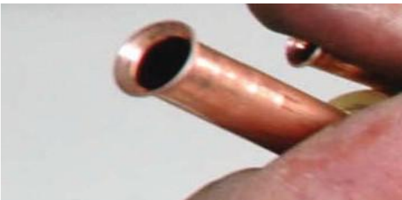
Figure 35: Flare the end of the tube (D)
